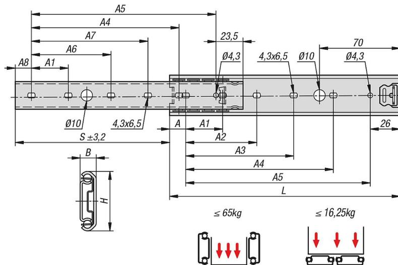
**텔레스코픽 레일, 스테인리스 스틸, 측면 장착용, 부분 확장형, 최대 하중 65Kg**
